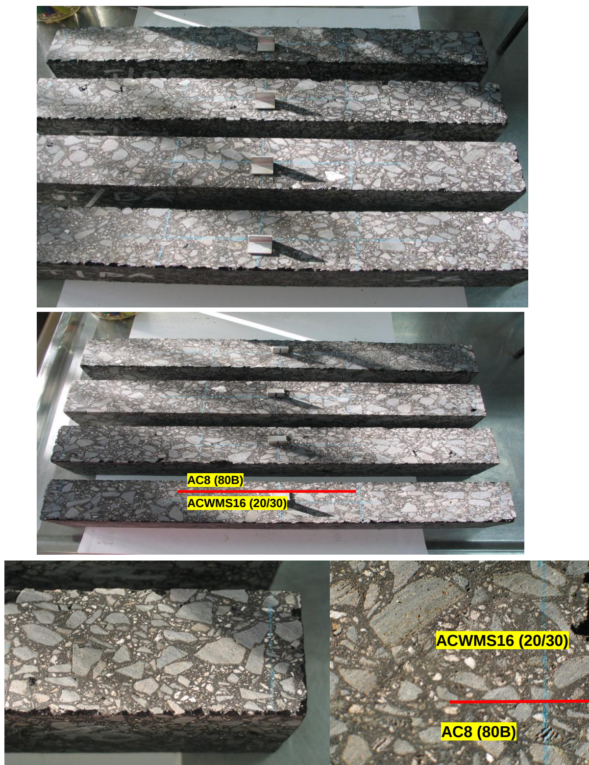
Rysunek 9 Fotografia belek wyciętych z pakietu warstw
